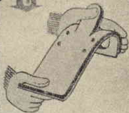
PIEGARE LA PLASTICA CALDA SULLA FORMA
